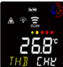
Abb. 9: Anzeige nach Alarmton
