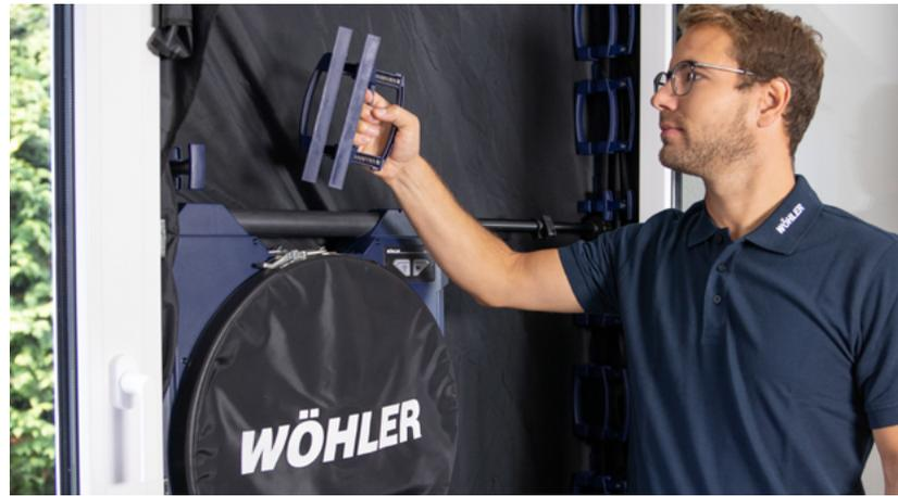
Einbau in Fenster und Türen durch ausgefeiltes Klammersystem. Fehlen Fenster-/oder Türrahmen noch, kann die Folie in einen optional erhältlichen Zusatz-Einbaurahmen eingesetzt werden.
