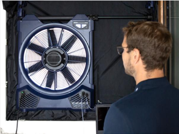
Vollautomatischer Messablauf gemäß DIN EN ISO 9972 oder DIN EN 13829 im gesamten Volumenstrombereich von 15 – 6.000 m<sup>3</sup>/h ohne Messblendenwechsel und Über- und Unterdruckmessungen ohne Ventilatorumbau.
