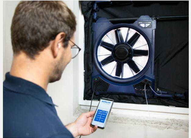
Die Ventilatoreinheit wird über die Wöhler BC 600 App gesteuert, die einfach auf Smartphone, Tablet oder Laptop (Android, iOS oder Windows 10) geladen wird.
