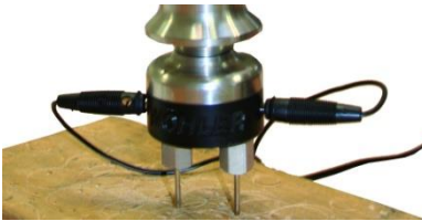
Abb. 9: Anschluss des Verbindungskabels an die Einschlagsonde
