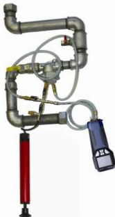
Abb. 35: Anschlüsse bei der Volumensmessung mit Wöhler DC 410 und Rußtestpumpe (ab 100 ml Rohrvolumen)
