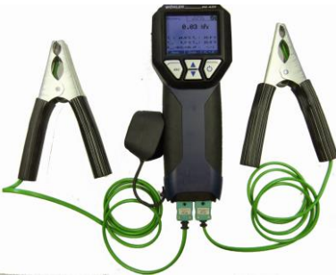
Abb. 4: Anschluss einer Temperaturmesszange
