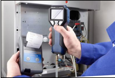
Abb. 44: Übertragung der Messdaten vom DC 410 zum Thermoschnelldrucker TD 600
