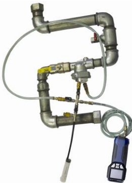
Abb. 34: Anschlüsse bei der Volumensmessung mit Wöhler DC 410 und Spritze (bis 100 ml Rohrvolumen)
