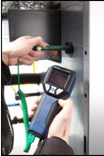
Abb. 42: Anwendungsbeispiel mit Oberflächentemperaturfühler
