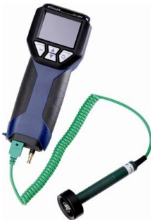
Abb. 5: Anschluss eines Oberflächentemperaturfühlers zur U-Wertmessung
