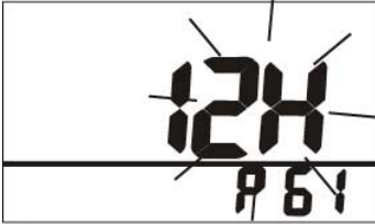
Abb. 25: Auswahl zwischen 12-Stunden und 24-Stunden-Anzeige
