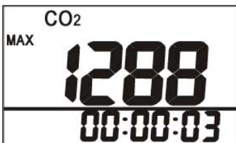
Abb. 10: Anzeige des maximalen CO 2 -Wertes
