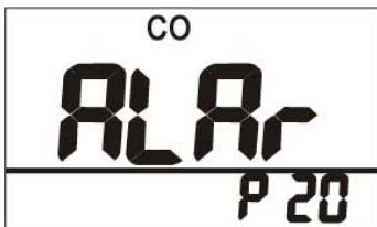
Afb. 19: Setup - Instellen van de CO-alarmdrempel
