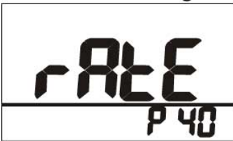
Abb. 21: Setup – Einstellen der Lograte
