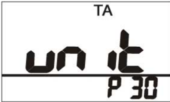
Afb. 20: Setup – Keuze van de temperatuureenheid
