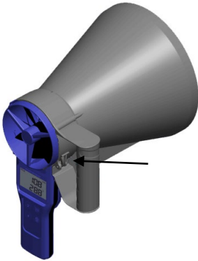
Abb. 7: Wöhler FA 410/430 in einen runden Messtrichter eingesetzt
