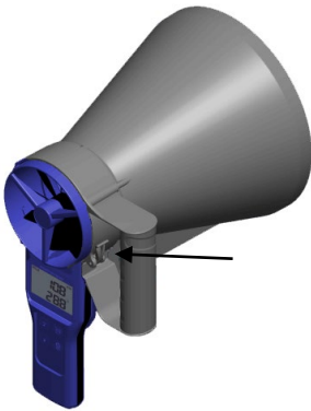
Fig. 29: Wöhler FA 410/430 conectado a una tolva redonda
