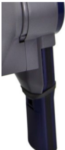
Abb. 8: Wöhler Flügelradanemometer auf den Trichter montiert und mit Gummiring gesichert
