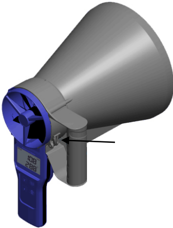
Afb. 7: Wöhler FA 410/430 toegepast in een ronde meettrechter
