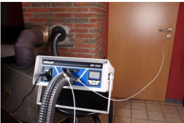
Abb. 59: Wähler DP 600 mit angeschlossenen Kapillarschläuchen während der 4PA Messung
