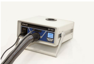
Abb. 31: Anschlüsse am Messgerät für Dichtheitsprüfung, Typ N: Netzkabel, Druckanschlussschlauch und Kunststoffschlauch
