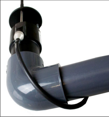
Abb. 32: Verbindung von Sonde und Verlängerungsrohr
