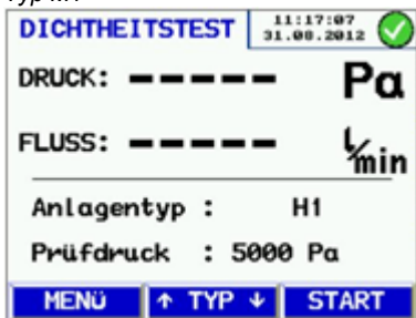
Abb. 41 Dichtheitsprüfung an Anlage Typ H1
