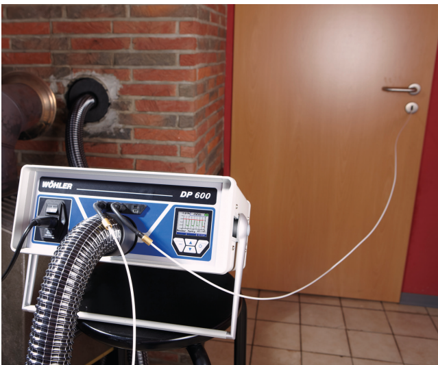
4 Pa- Test im ausführlichen Verfahren.
