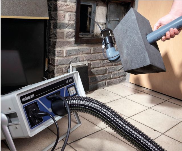
Prüfung eines Rauchfangs Typ N im Unterdruckbetrieb bei einem Prüfdruck von 20 Pa oder 40 Pa.
