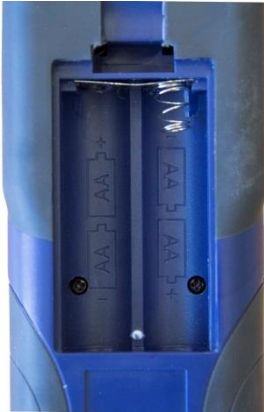
Abb. 4: Geöffnetes Batteriefach auf der Geräterückseite
