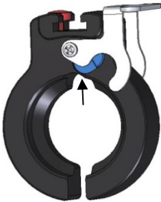
Fig. 30: Crochet avec bride de serrage ouverte, rainure marqué par une flèche.
