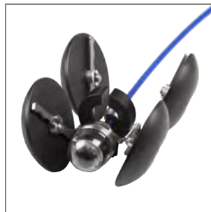
Selbst in umgekippter Position ist der Kamerawagen weiterhin einsatzbereit.
