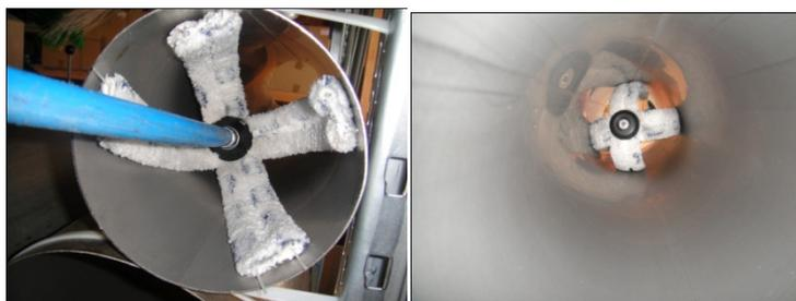
4. Die Reinigung ist auch ohne vorherige Besprühung mit dem Softsprayer gewährleistet. In diesem Fall muss der **Spider-Mob AM** mit Reinigungsmittel leicht angefeuchtet werden. Eventuell muss der Vorgang dann mehrmals wiederholt werden.
