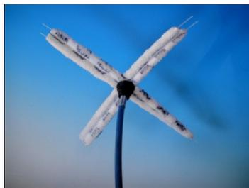
1. Zuerst wird der Luftkanal mit der **Airmaster – Mini** Reinigungswelle mittels Bürste vorgereinigt. Damit werden die losen Verschmutzungen zum grössten Teil entfernt.
