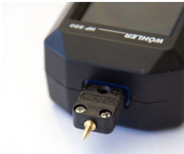
Abb. 22: Geräteoberseite mit eingesteckter Temperatursonde
