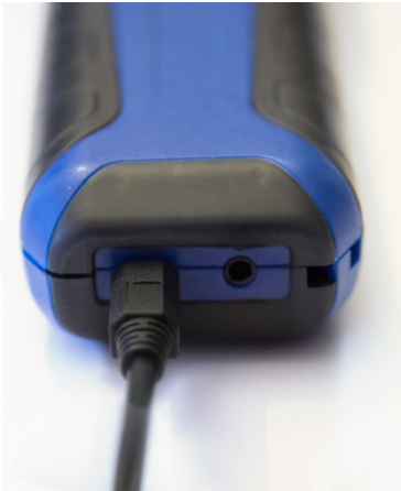
Abb. 23: Geräteunterseite mit angeschlossenem Kabel der Feuchtwaaage
