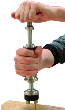
Abb. 16: Einschlagen der Wöhler Einschlagssonde
