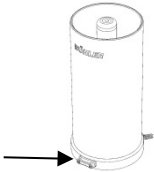
Abb. 46: Kalibrierbuchse für Prüfstelle, mit Pfeil markiert
