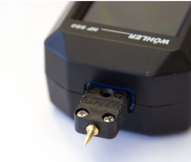
Abb. 12: Geräteoberseite mit eingesteckter Temperatursonde
