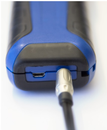
Abb. 13: Geräteunterseite mit angeschlossenenem Kabel der Einschlagssonde
