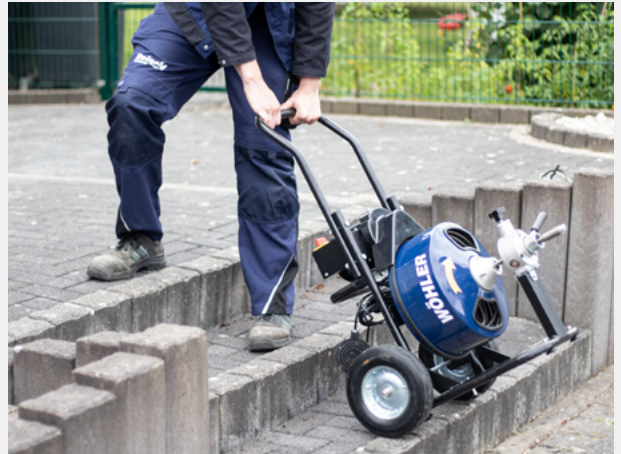
Leichter Transport der Wöhler RM 400 Rohrreinigungsmaschine durch große robuste Rollen.
