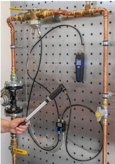
Abb. 20: Anschlüsse Dichtheitsprüfung
