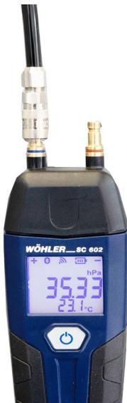
Abb. 7: Höherer Wert über negativen Druckanschluss gemessen
