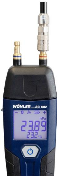
Abb. 6: Höherer Wert über positiven Druckanschluss gemessen
