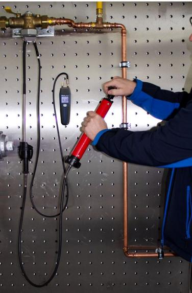
Abb. 30: Rohrvolumenmessung mit Wöhler M 603 und Rußtestpumpe
