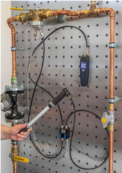
Abb. 14: Anschlussbeispiel mit dem Wöhler Gasleitungsdichtheitsprüfset für die Belastungsprüfung
