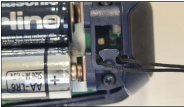
Abb. 2: Befestigung der Handschlaufe unterhalb des Batteriefachs
