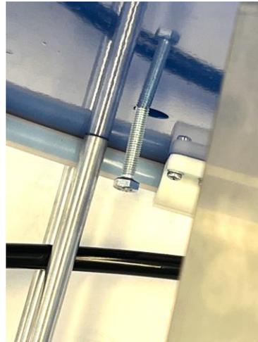
Bild 2: M5 Sicherungsschraube angebracht
