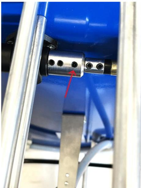
Figure 3 : vis de blocage de l'arbre
