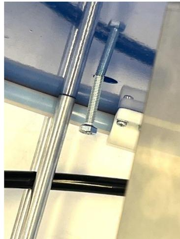
Figure 2 : vis de sécurité M5 en place
