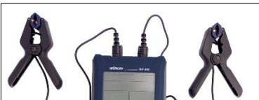
Abb. 4: Anschluss der Temperaturzangen
