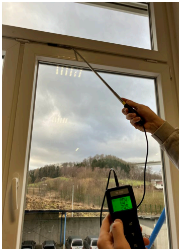
Abb. 3: Leckage-Detektion am Fenster- rahmen
