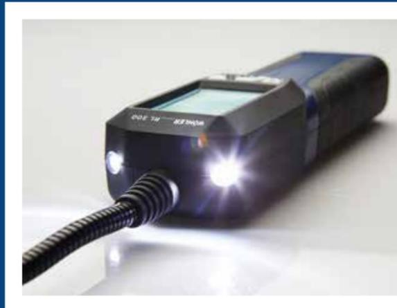
Lässt Dich nicht im Dunkeln: In dunkler Umgebung schalten sich automatisch die Displaybeleuchtung sowie zwei LED-Lampen ein
