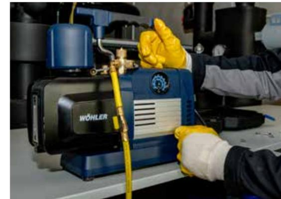
Über die Vakuumanzeige hast du den Evakuierungsprozess immer im Blick
