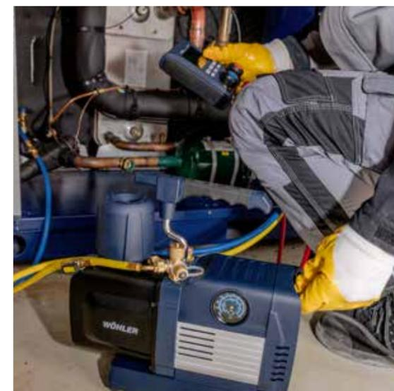
Tuyaux de raccordement avec vannes à bille pour une fermeture et une ouverture rapides.
