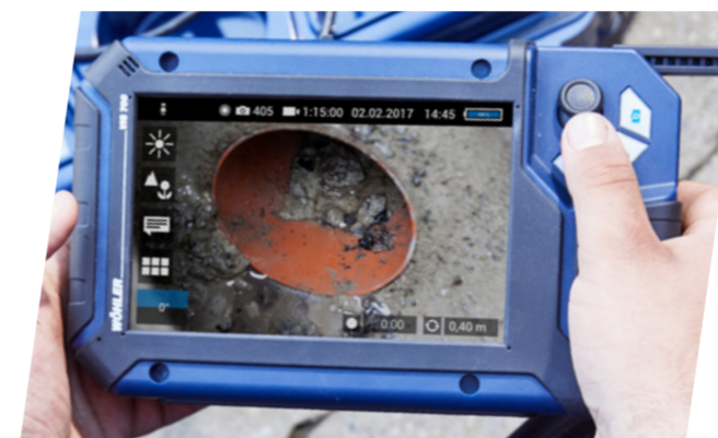
■ Lage und Winkelanzeige lässt den Benutzer immer erkennen, wo im Rohr oben und unten ist.
