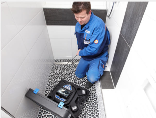
Bis 3 bar wasserdichter, robuster Farbkamerakopf mit \varnothing 26 mm lässt sich durch mehrere 87^\circ -Bögen in Rohrleitungen von \varnothing 40 mm schieben.
