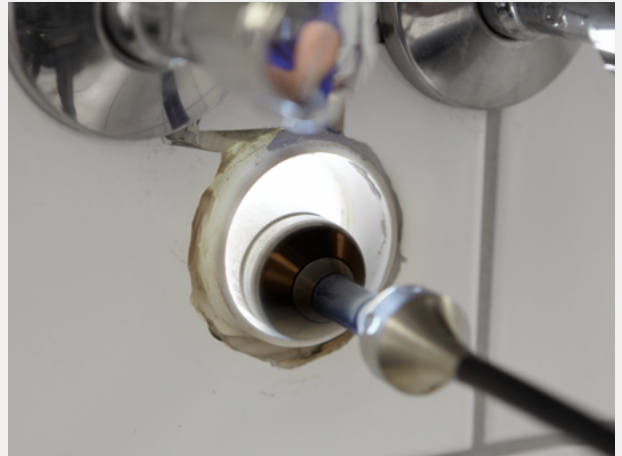
Dank 12 LEDs liefert der Farbkamerakopf gestochen scharfe Bilder selbst aus dunklen Bereichen.
