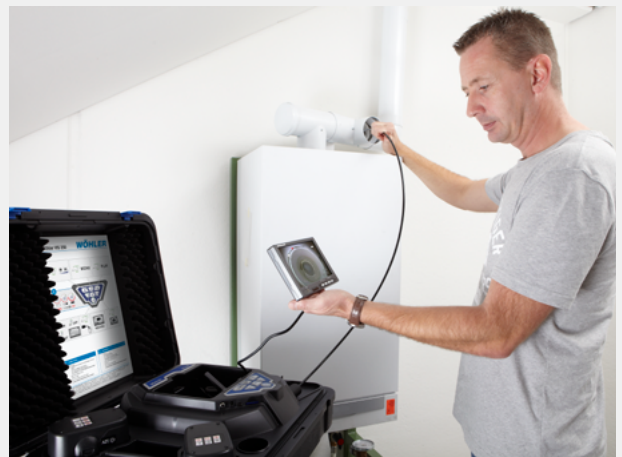
Bis zu 2 Meter herausnehmbarer TFT-Breitbild-Farbmonitor zeigt brillante Bilder, die über den Videospeicher auf der SD-Karte gespeichert werden können.
