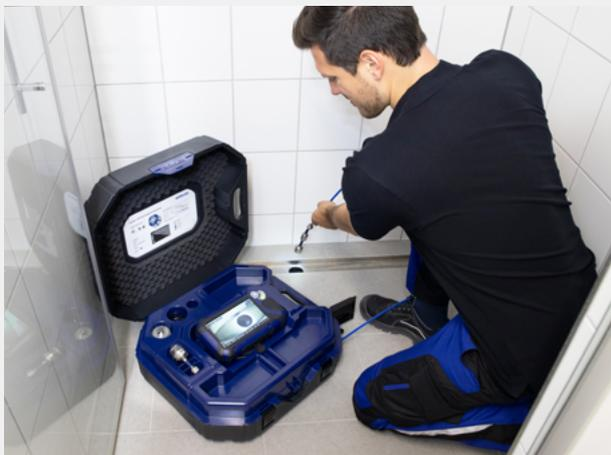
La tête de caméra étanche de Ø 26 mm permet des inspections en totale immersion, dans un environnement humide.
